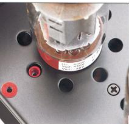
Eine kleine Buchse ist neben jeder Endröhre angeordnet. Das sind die Messpunkte zur Ruhestromeinstellung
