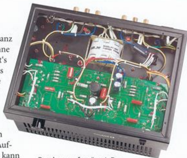
Durchaus aufgeräumt: Der Dynavox-Aufbau findet im Wesentlichen auf einer großen Platine statt
